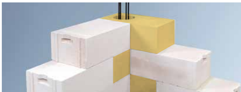
Vazba zdiva a pilířovek s vloženou výztuží
